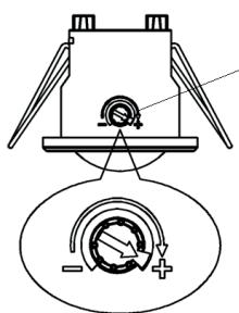
Potentiomètre pour ajuster le niveau d'éclairage.
