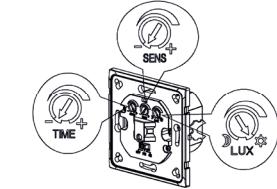
Stellen Sie den Funktionsschalter auf "ON", drehen Sie den TIME-Knopf gegen den Uhrzeigersinn auf Minimum. Drehen Sie den SENS-Knopf im Uhrzeigersinn auf das Maximum (+). Drehen Sie den LUX-Knopf im Uhrzeigersinn auf das Maximum (Sonne).
