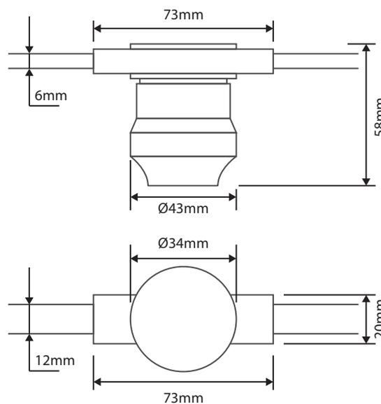
\* IP 65 sous réserve d'ampoules compatibles non fournies
