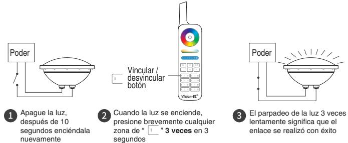
**!** Si la luz no parpadea lentamente, la conexión falló, pis apague la luz nuevamente y siga los pasos anteriores nuevamente.
