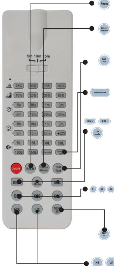
Appuyez sur le bouton «ON / OFF». Lorsque le témoin de charge entre en mode normal ou éteint, appuyez sur le bouton «RESET» et sur le bouton «Mode automatique» pour quitter le mode normal ou éteint.
