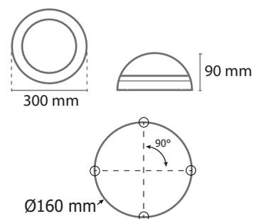
Schéma de pré-perçage de fixation
