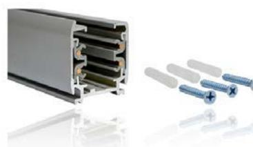
Le rail électrifié XTS est distribué en longueurs standards. Cependant, il peut être coupé selon le désir de la longueur, avec une scie à métaux ou une scie circulaire pour aluminium. Après avoir coupé le rail XTS, les conducteurs en cuivre doivent être repliés à 90°.
