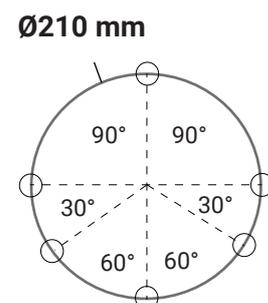
Schéma de pré-perçage de fixation
