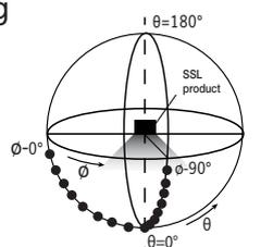
Luminaire installé à l'horizontal
