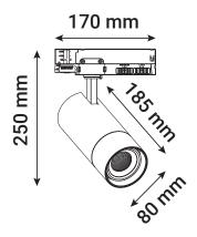
Pour régler l'angle : Faites tourner la baque indiquant les angles à l'avant du produit.
